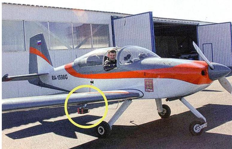
ПИЛОТИРУЕМЫЙ ЛЕТАТЕЛЬНЫЙ АППАРАТ С ЗАКРЕПЛЁННОЙ АЭРОФОТОСЪЁМОЧНОЙ ПЛАТФОРМОЙ
